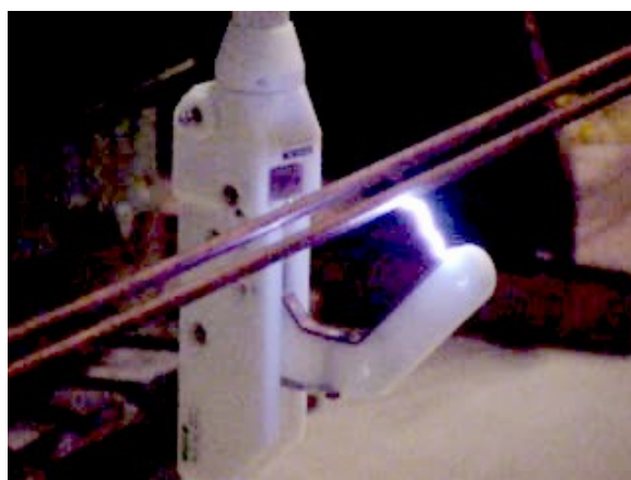
Figure A.19 – Décharge entre conducteurs à travers l'air
