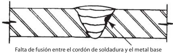
(a) Falta de fusión en la pared lateral
